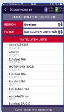
● **Multifeed-Empfang** – Mit dem Satfinder SF03-BT lassen sich auch Multifeed-Anlagen perfekt einmessen. Im Satellitenmenü einfach die jeweiligen Satelliten auswählen und schon wird die DiSEqC-Funktion aktiviert
