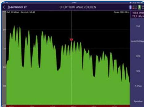
● **Spektrumanzeige** – Das Spektrum zeigt die Signalpegel der einzelnen Satellitenkanäle: Schräglagen, Einbrüche und Störsender lassen sich so finden
