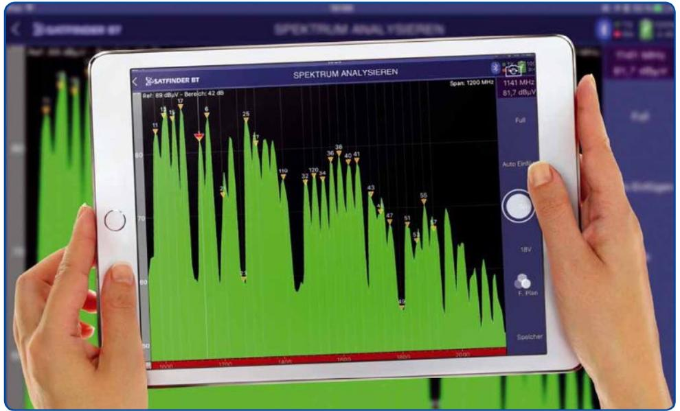
Wer an einem Unicable-System oder einer Multifeedanlage hängt, kann innerhalb der Satfinder-App auf Unicable- oder Multischalterbetrieb umstellen. Das SF03-BT analysiert DVB-S und DVB-S2-Signale, beim Wechseln der Messfunktionen muss man allerdings unter Umständen die Satellitenposition neu eingeben.
