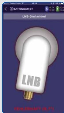
● **LNB-Ausrichtung** – Durch Drehen des Smartphones erfolgt die exakte Winkelberechnung für den LNB. Hierfür greift die App auf die GPS-Koordinaten zurück
